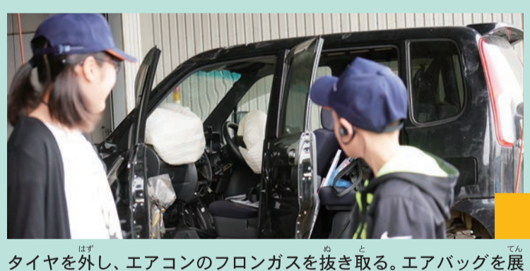
タイヤを外し、エアコンのフロンガスを抜き取る。エアバッグを展開させる。このあと油や不凍液などの液体を抜き取る。
