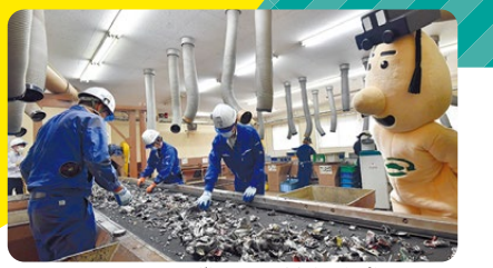
▲鉄やアルミニウム、銅などの貴重な資源を素材ごとに回収
