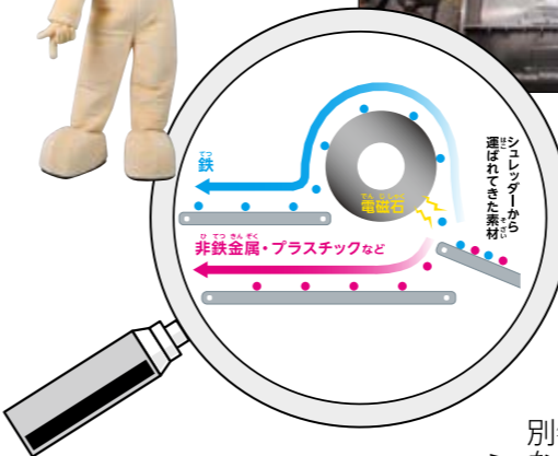
金属資源等の素材ごとの分別は、まずそれぞれの性質を利用して機械で行われます
