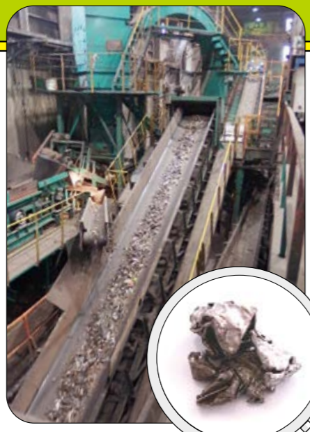
青森工場は、重さにして1時間に約40~50tの破碎処理ができます。また、メインシュレッダーでは、細かく砕くだけでなく丸い状態にします
