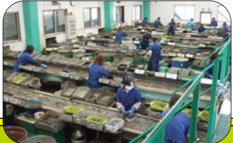
機械による分別後、人の手でさらに不純物が取り除かれます
