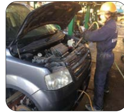
フロンガスの回収は、外にもれないよう細心の注意を払って
