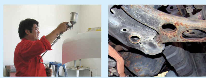
▲さび止めの塗装をすれば安心! ▲潮風でさびてしまった部品
