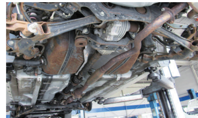
全体がさびだらけになってしまうと、修理できないことも…
