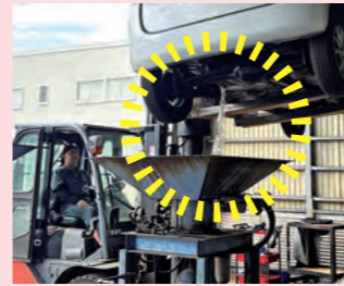
ドリルで車体のタンクに穴を開けるよ
