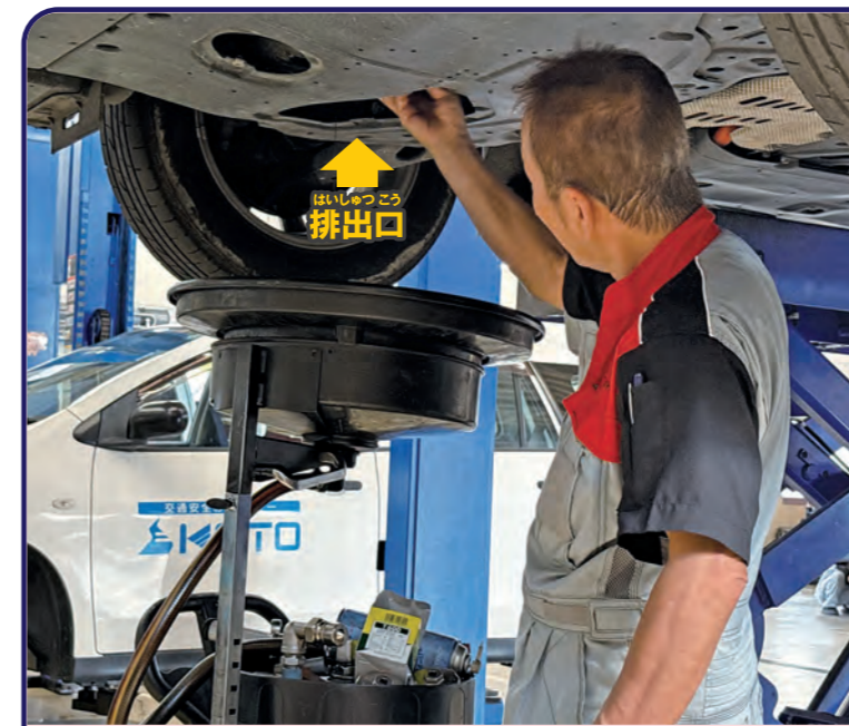
車体を高く持ち上げて、古いオイルを排出するよ
