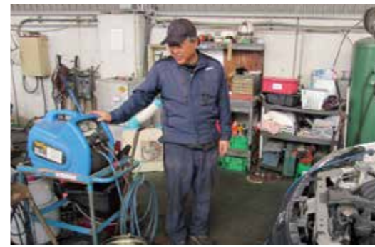
専用のポンペにガスを吸い込んで回収するよ
