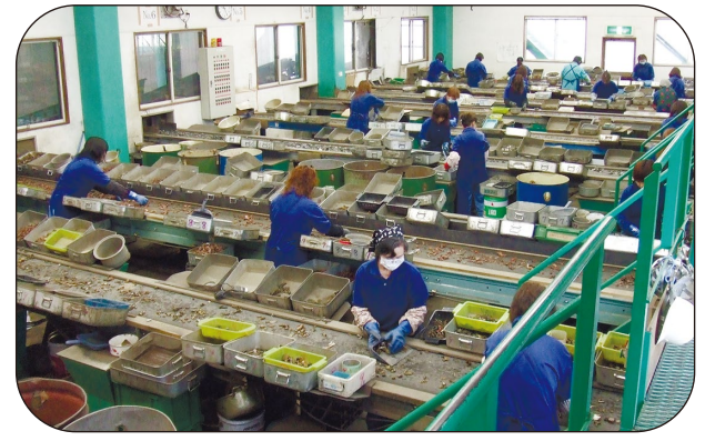
機械による分別後、人の手でさらに不純物を取り除かれます
