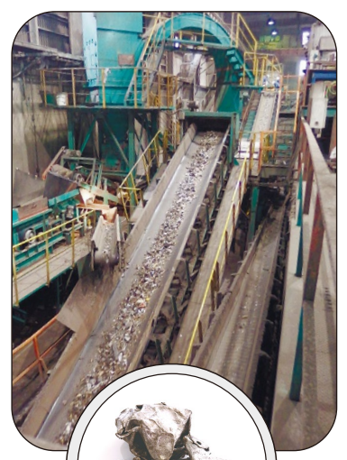
青森工場は、重さにして1時間に約40〜50tの破砕処理ができます。また、本シュレッダーでは、細かく砕くだけでなく丸い状態にしています。このようにすることで、素材同士がからまりにくくなり、その後の分別がしやすくなります。
