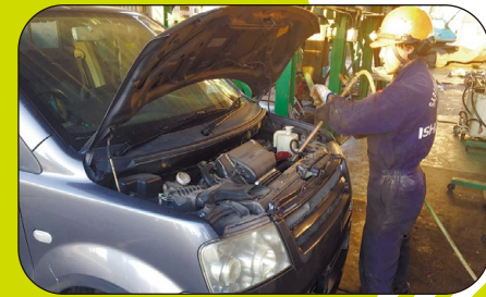
外にもれないよう、フロンガス回収は細心の注意を払って
