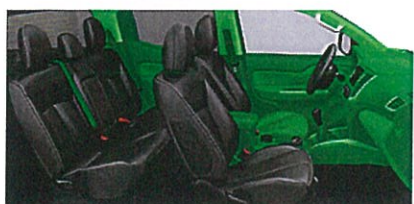
2014年発売新型プラットフォームにおけるリサイクル容易な熱可塑性樹脂の主な採用箇所(グリーン部)
