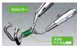
O<sub>2</sub>センサーとメタルハニカム触媒を搭載したマフラー
