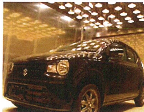
新たに導入した恒温恒湿槽での車室内VOC測定の様子
