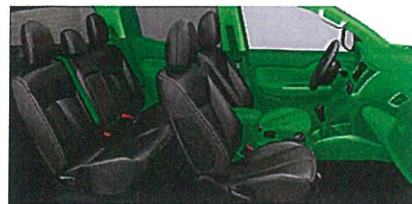
2014年発売新型トラックにおけるリサイクル容易な熱可塑性樹脂の主な採用箇所(グリーン部)
