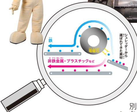
シュレッダーで細かく砕かれた金属資源等はそれぞれの素材の性質を利用して分別されます。安東社長は「素材で最も多い鉄は磁石を使った磁選機で分別し、アルミニウムも磁力を帯びさせてアルミ選別機で分別します。
