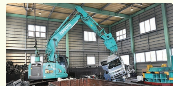
▲このニブラは電気で動くため、ガスを出さず、音が小さいのも特長！
