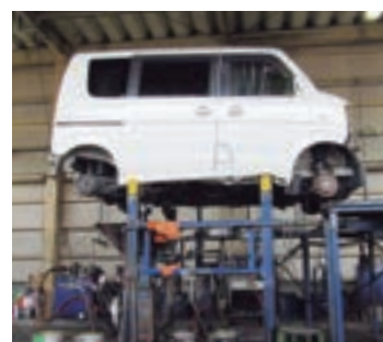
▲タンクに穴を開けて燃料を抜き取るんだ
