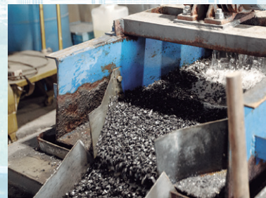
エアバッグ類(上)やフロン類(中)を分解、 シュレッダーで破碎する様子(下)
