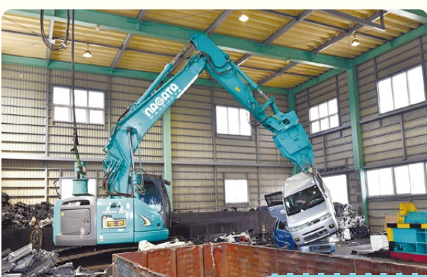
▲このニブラは電気で動くため、ガスを出さず音が小さいのも特長!
