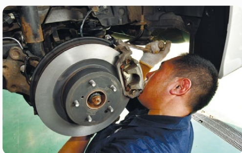
▲ディスクローター(タイヤの回転を止める部品)の交換にもリサイクル部品を使用することがあります
