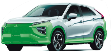
「エクリプス クロス」 熱可塑性樹脂の 主な採用箇所
