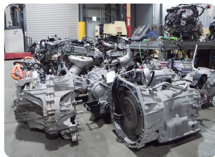
廃車からまだ使える部品が丁寧に取りはずされ、状態をしっかりチェックした上で再使用される(写真上はドア、下はトランスミッション)
