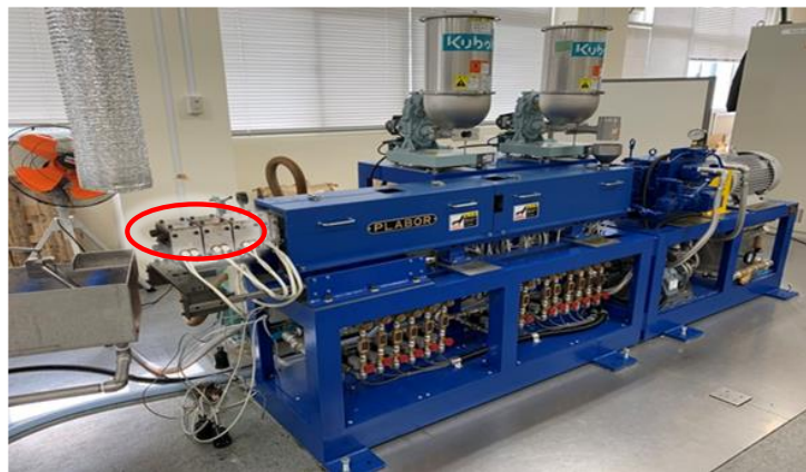
図 5 溶融樹脂溜まり部（図中赤丸）を備えた押出機
