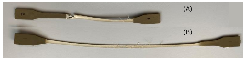
図 6 引張試験後の各ダンベルの状態 (A):原料からのダンベル、(B):再生処理試料からのダンベル
