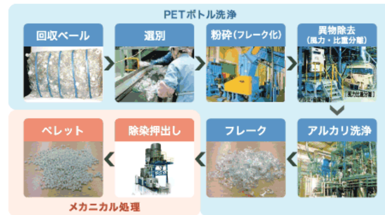
図3 メカニカルリサイクル法のフロー
