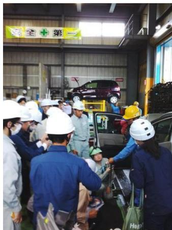
エアバッグ類の取外し回収
