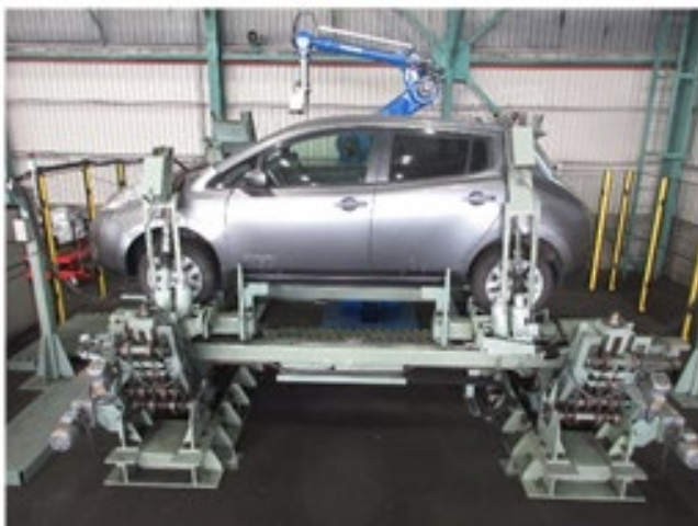
①車体の固縛が完了した状態
