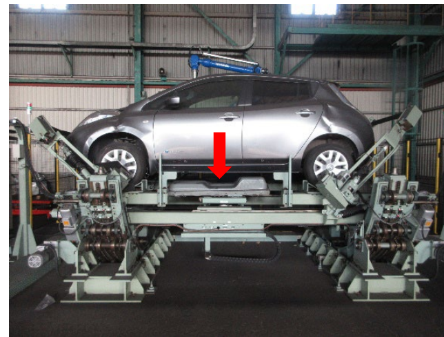
④シフトリフト装置がLIBユニットを 取り外した状態
