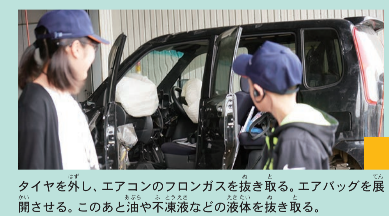
タイヤを外し、エアコンのフロンガスを抜き取る。エアバッグを展開させる。このあと油や不凍液などの液体を抜き取る。
