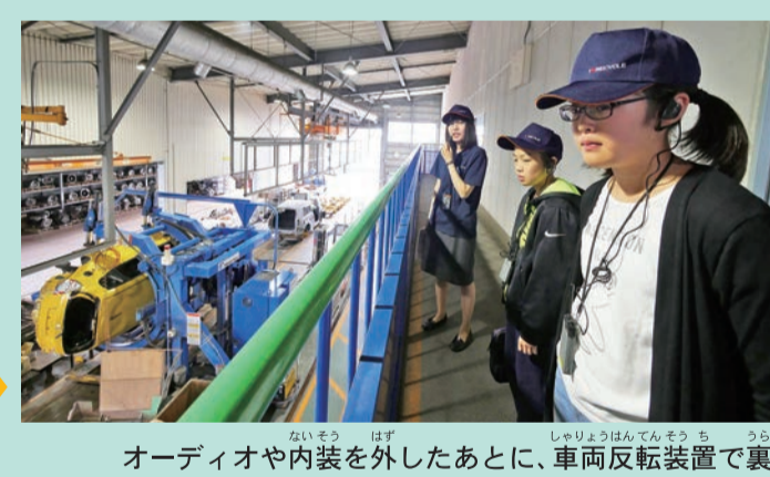
オーディオや内装を外したあとに、車両反転装置で裏側を出してから、駆動系を解体し、燃料タンクを回収。
