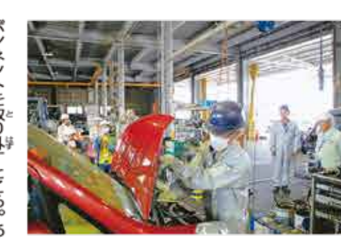
ボンネットを取り外すところ。あと1つ1つ外してしまします
