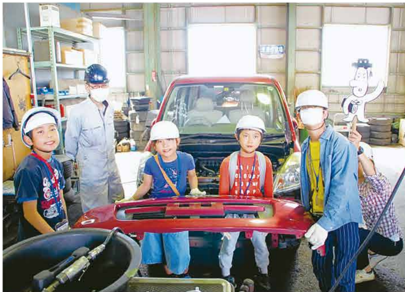
取り外したバンパー。素材はPP（ポリプロピレン）です
