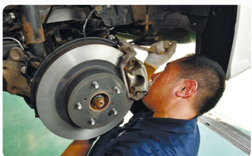
▲ディスクローター（タイヤの回転を止める部品）の交換にもリサイクル部品を使用することがあります
