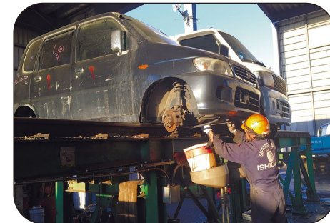
解体工場では、まずガソリンやオイルを回収します
