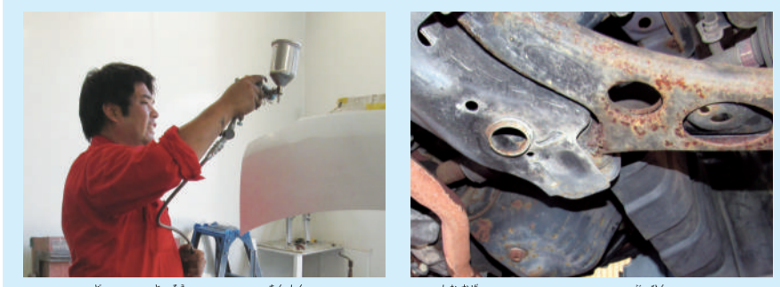
▲さび止めの塗装をすれば安心! ▲潮風でさびてしまった部品
